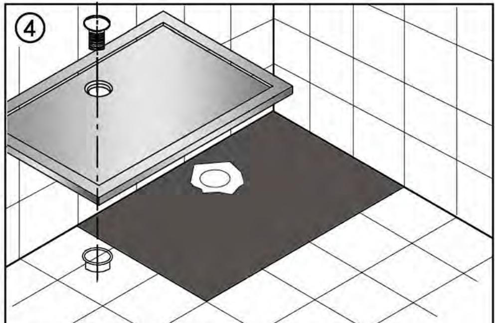
Installer le receveur sur une légère couche de ciment. Prendre note qu'en rajoutant de l'eau au mélange adhésif, le collage sera renforcé; il est conseillé d'appliquer une couche de base avant l'installation du receveur.
