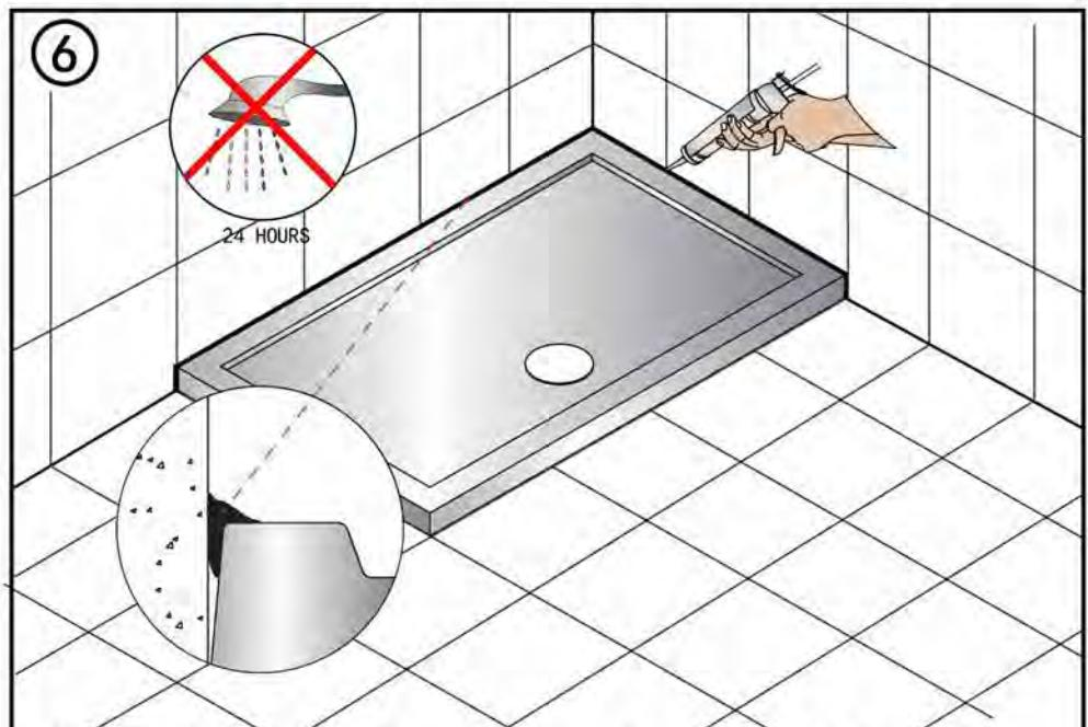
Faire des joints étanches entre le receveur et le mur avec du silicone anti-fongique et laisser reposer 24 heures.
