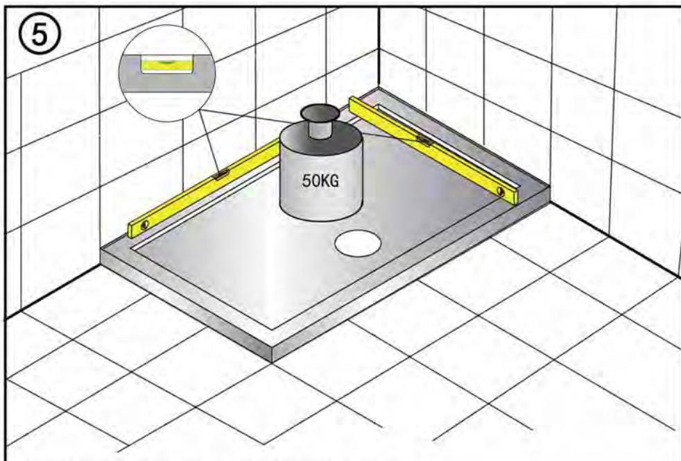
Mettre le receveur à niveau et laissez-le immobilisé pendant 24 heures.
